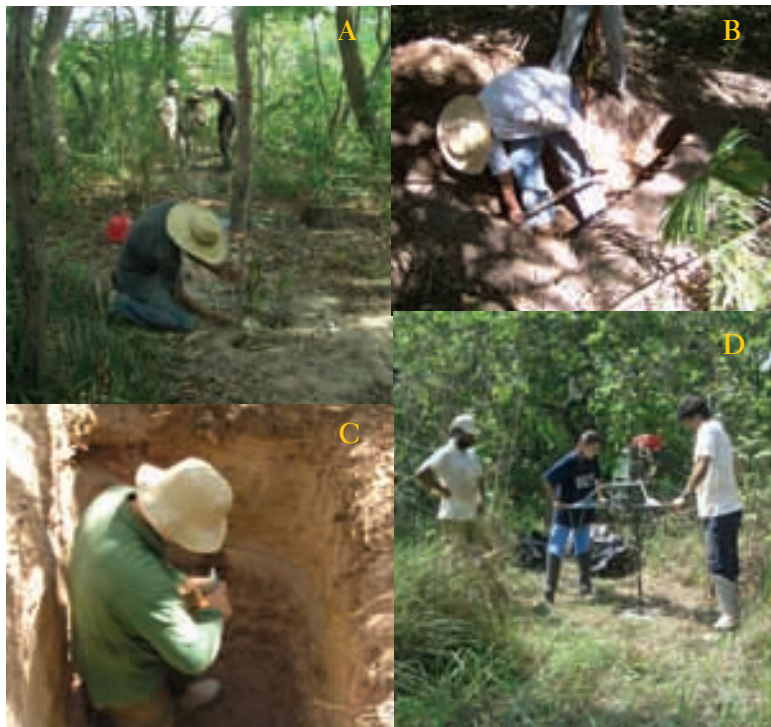
FIGURA 2: A = Medidas topográficas em cordilheira, B = Abertura de trincheira, C = Descrição morfológica e coleta de amostras de solo e D = Tradagens para análise do sistema pedológico Panossolo-Plintossolo.
