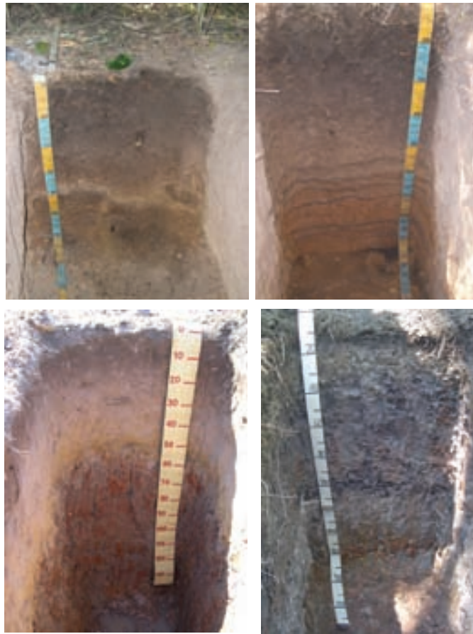
FIGURA 12: Descrição pedológica dos perfis e classificação dos solos (Vertissolo, Cambissolo, Planossolo e Plintossolo) (BEIRIGO et al., 2011).
