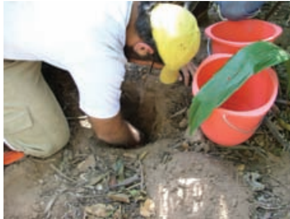
FIGURA 10: Coleta de solos para porcentagem de carbono e densidade (anel volumétrico).
